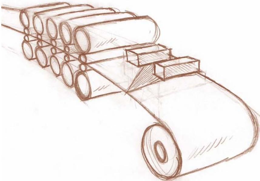
La forma di base del nastro creato in un laminatoio a caldo rimane costante durante l'intero processo di produzione. Ma il fumo, il vapore, la polvere e la ventilazione che derivano dalle differenze di temperatura fra i sensori ed il materiale nella produzione, creano un ambiente che rende molto più difficile il processo di misura. L'alta temperatura dell'acciaio con le alte velocità e sollecitazioni, mettono alla prova i limiti dei sistemi.
